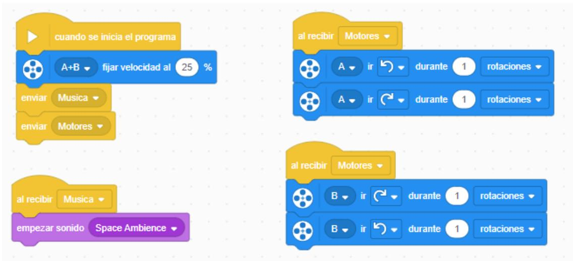
Configuramos los motores a una potencia del 25%
